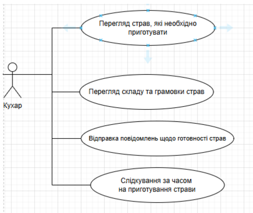
Рисунок А.1. UML-діаграма варіантів використання для ролі кухаря
