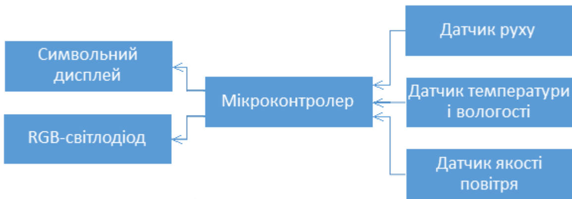
Рисунок 3.1 Структурна схема системи (рух справа наліво)
