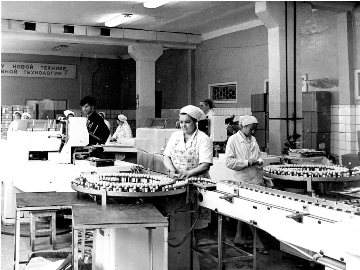
Рис. 4. Автоматизований розлив лікарського засобу «Корвалол» на Київському хіміко-фармацевтичному заводі ім. М. Ломоносова у 1960 році 287
