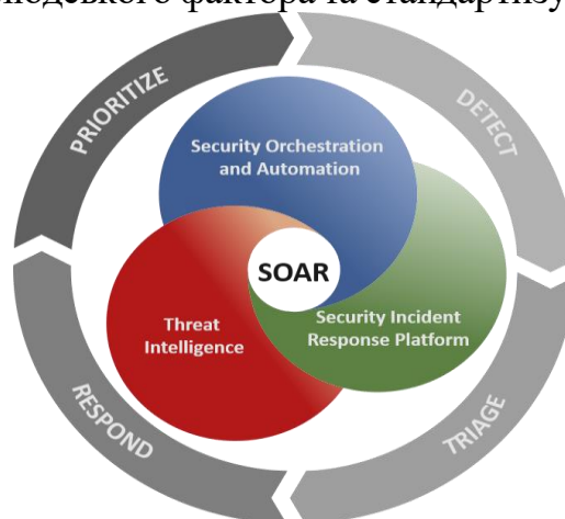
Рис. 4.23. Ключові компоненти SOAR: оркестрація, реагування, автоматизація
