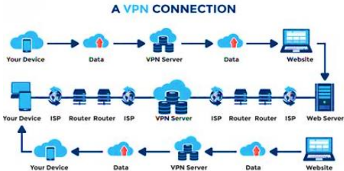
Рис. 6.4. Принцип роботи VPN-з'єднання у корпоративній мережі Джерело: URL: https://www.netacad.com/courses/cybersecurity/
