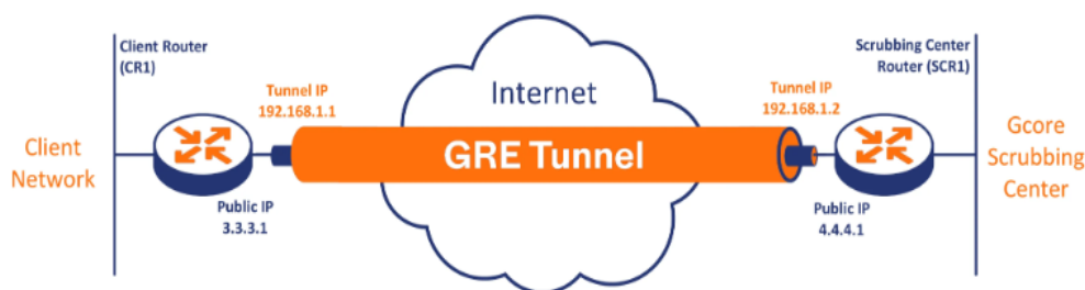
Рис. 6.5. Схематичне зображення GRE-тунелювання між клієнтською мережею та центром очищення трафіку
