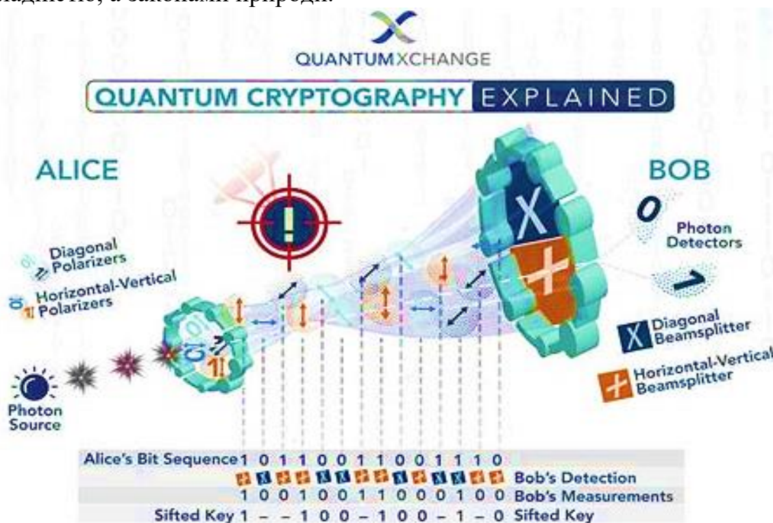
Рис. 5.5. Принципова схема роботи квантової криптографії (QKD) за протоколом BB84
