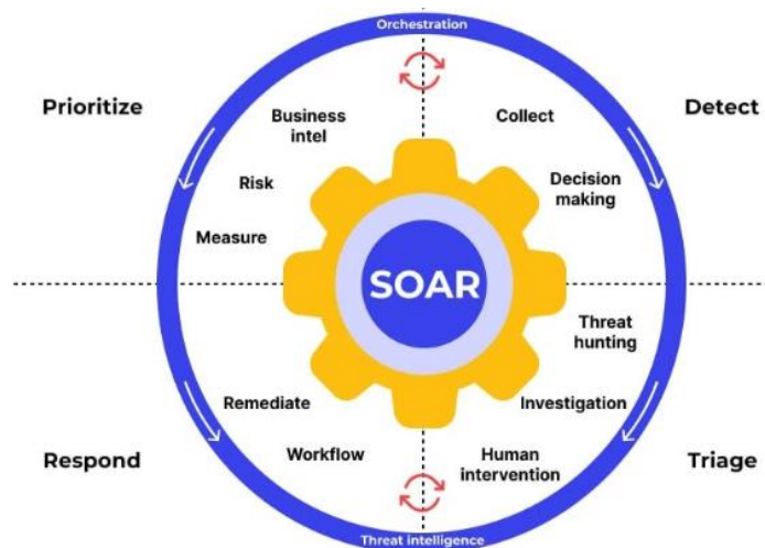
Рис. 4.5. Архітектура та принцип роботи платформи SOAR (Security Orchestration, Automation and Response)
