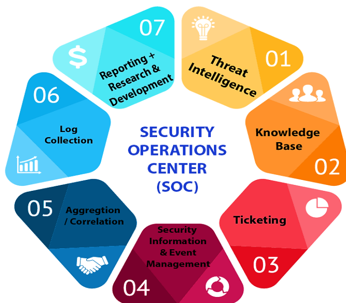
Рис. 2.6. Структура та основні функції центру безпеки SOC (Security Operations Center)
