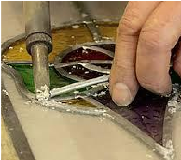
Рис. 29. Процес паяння металевої свинцевої жили. 2025. м. Косів, Україна. Фото [Архів Мацідон А.С.].
