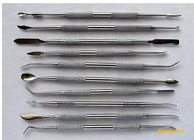
Рис. 28. Набір металевих стеків для декорування металевою свинцевою жилою. 2025. м. Косів, Україна. Фото [Архів Мацідон А.С.].
