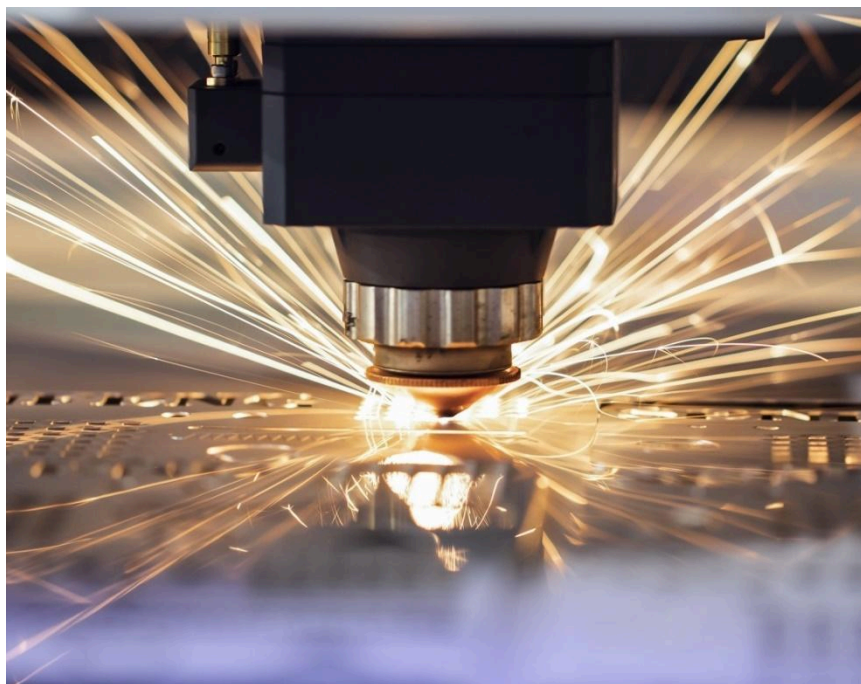
Рис. 15. Процес лазерної різки сталі до проєкту «Сяюча Слава Безсмертя». 2025. м. Київ, Україна. Фото [Архів Мацідон А.С.].
