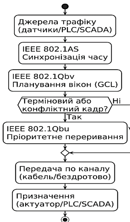
Рис. 2. Блок-схема роботи рівня TSN у гібридній промисловій мережі
