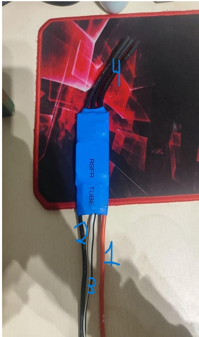
Рисунок 3.3. Схема підключення ESC-регулятора до двигуна та контролера
