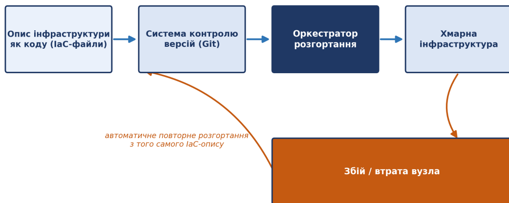
Рис. 14.2. Конвеєр Infrastructure as Code та автоматизоване відновлення хмарної інфраструктури після збою Джерело: розроблено автором
