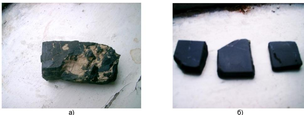
Рис. 1. Внешний вид образцов лидита: а) необработанного; б) подготовленного к исследованиям
