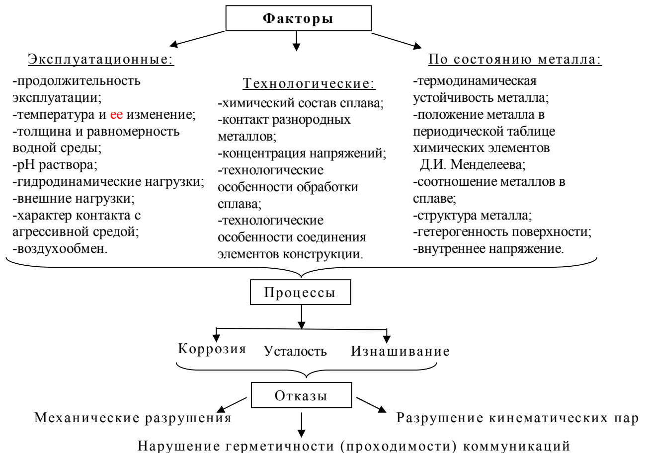
Рисунок 1. Влияние коррозионных факторов на процессы повреждения водопенных коммуникаций
