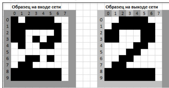
Рис. 2 – Искаженное и восстановленное изображение цифры 2 на входе и выходе НС Хопфилда после одной эпохи ее работы.
