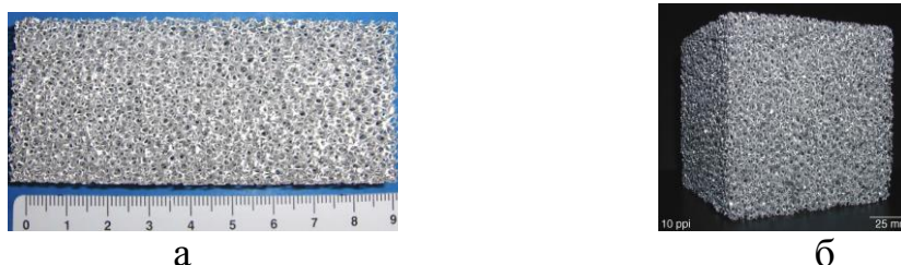
Рис. 1. Структура ПМ, полученного: а) литьем из алюминия [9]; б) методом порошковой металлургии из сплава Fe-Cr-Al-Y [10]
