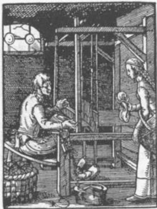
Рис. 4. Горизонтальний ткацький верстат. Німецька гравюра XV ст.
