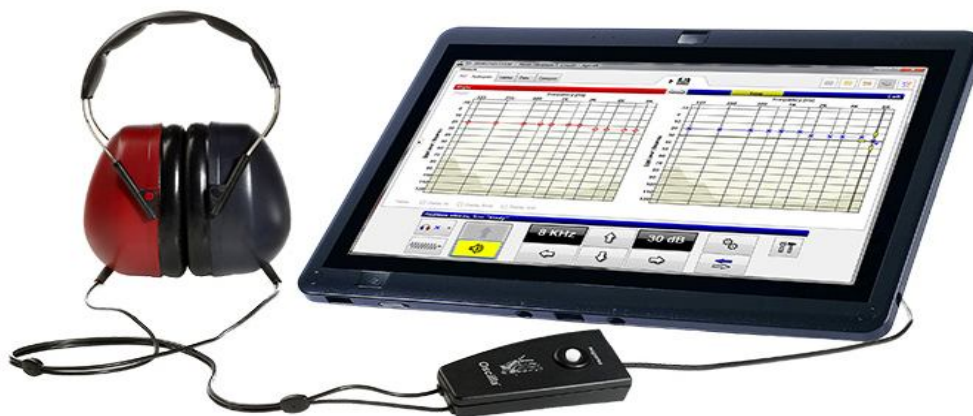
Рис. 3. Портативний амбулаторний/клінічний аудіометр. Модифікація: Oscilla USB-310
