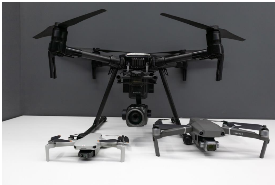
Рис. 1. DJI Mini2, Mavic 2 Pro і Martrice 200 з камерою Zenmuse Z30 (загальний вигляд)
