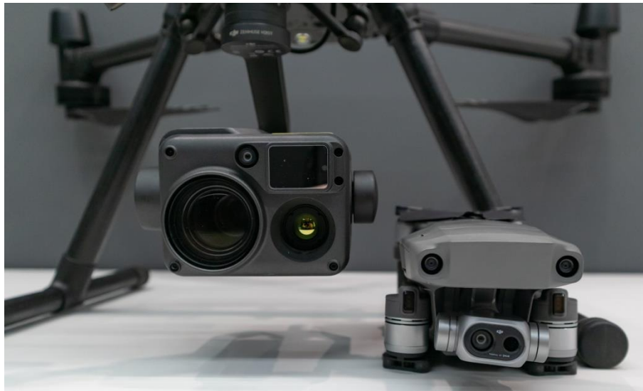
Рис. 4. Камери DJI Mavic 2 Enterprise Dual та DJI Zenmuse H20T
