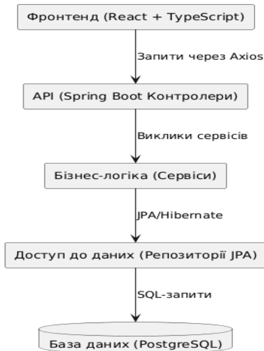
Рисунок 2.1. Багатошарова архітектура вебдодатку системи електронного запису пацієнтів
