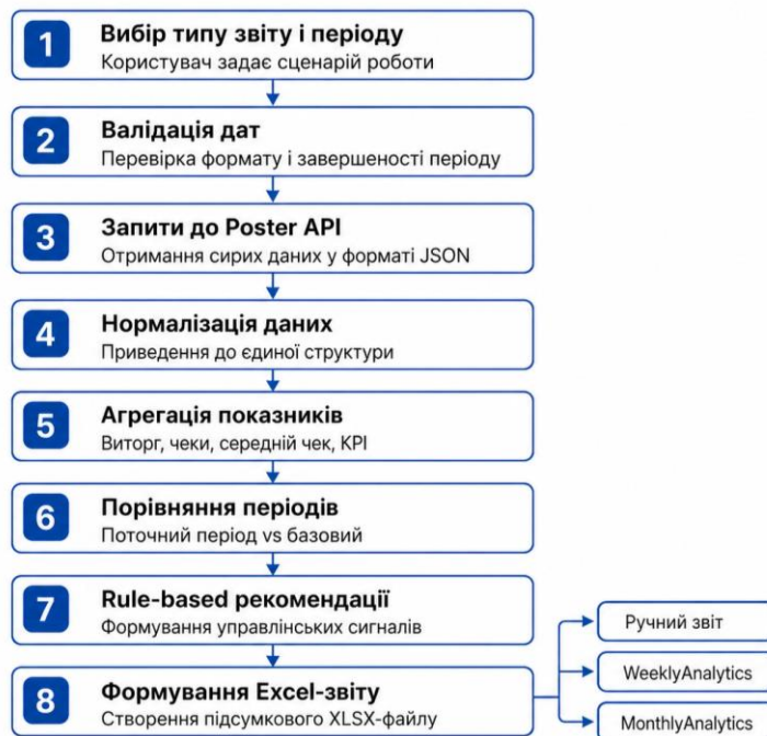
Рисунок 2.2 .Узагальнена схема обробки даних у системі
