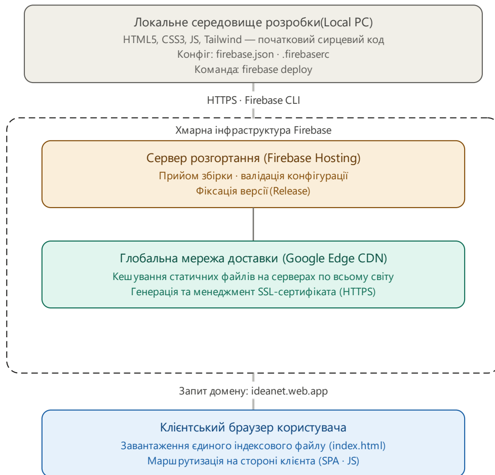
Рис. 3.7.Схема процесу розгортання та архітектура дистрибуції вебзастосунку IdeaNet через Firebase Hosting
